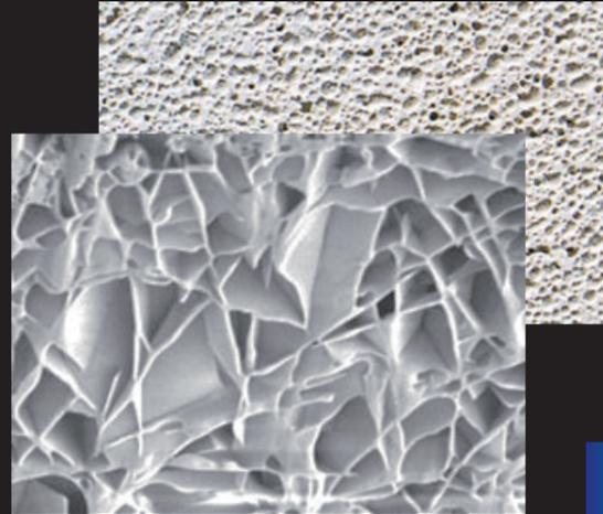
オートクレーブ養生により、緻密なトバモライト結晶体を生成したパネルです。とても安定した構造なので、そり、たわみ等の変形が起きにくい優れた外壁材です。トバモライトとは、スコットランドのマル島にある穏やかな港町トバモリーにて発見された天然石の結晶体です。
