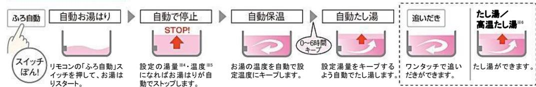
※4: 100L~500L(20L刻み)の湯量設定ができます。ふろ湯量設定の最低湯量はふろ接続アダプターの位置および浴そうの大きさによって変化します。 ※5: 6~9・16°C~48°Cの1°C刻みで湯温設定ができます。 ※6: メニュー内の「たし湯」を選択すると設定温度のお湯を約20L、「高温たし湯」を選択すると約60°Cのお湯を約20L注ぎます。
